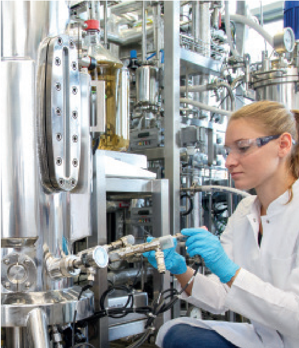
Sterile Probenahme an der Bioreaktorstraße im Technikum im Fachgebiet Bioverfahrenstechnik
